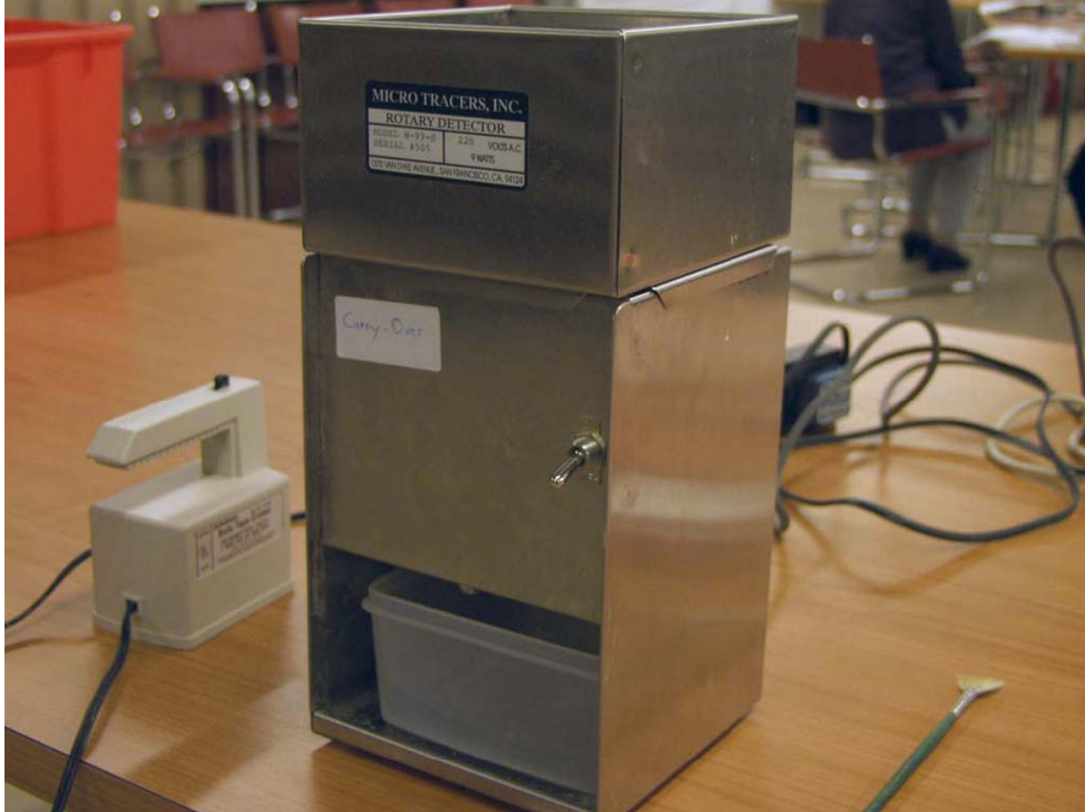
Der Rotationsdetektor filtert eine abgewogene Probe; danach können die Eisenteilchen entmagnetisiert werden.
